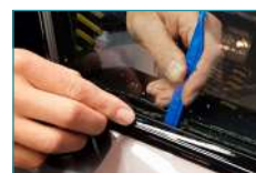
La queue effilée est assez rigide, mais suffisamment souple pour repousser les caoutchoucs des fenêtres et autres parties de la carrosserie du véhicule. Parce qu'elle est effilée et très lisse, c'est un excellent outil pour positionner les films de vitrage avant que l'eau ne soit raclée.
