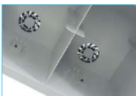
Ventilateurs qui refroidissent le compartiment après chaque mesure.
