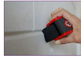
Sur cette image, vous pouvez voir que la roue en mousse dure prend facilement la forme de la surface incurvée.
