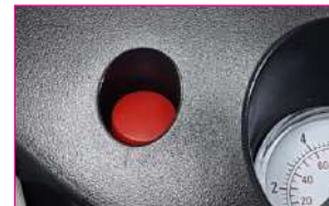
Il suffit d'appuyer sur le bouton et toute la pression est évacuée du réservoir.
