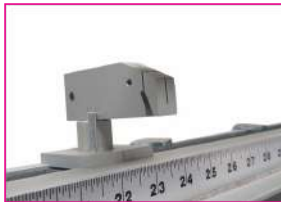
Le Filmhandler dispose de 2 lames réglables, ce qui vous permet de couper deux ou trois travaux en même temps.
