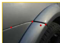
Une bonne application dépend d'une bonne adhérence. Cela va sans dire. Malheureusement, le nettoyage et le dégraissage des zones les plus critiques sont négligés. Il s'agit notamment des joints, des rebords et des interstices de la carrosserie. C'est exactement là que le film a tendance à se détacher et à gondoler.
