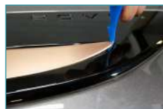
Le Factum II a subi quelques améliorations par rapport à la version I! La pointe s'effile et a un bord plus tranchant. Elle est à la fois rigide et flexible. Cela permet d'appliquer une grande force pour pousser le film dans les plus petits canaux et plis, sans pour autant le casser.
