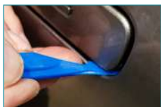
Le Factum II a subi quelques améliorations par rapport à la version I! La pointe s'effile et a un bord plus tranchant. Elle est à la fois rigide et flexible. Cela permet d'appliquer une grande force pour pousser le film dans les plus petits canaux et plis, sans pour autant le casser.
