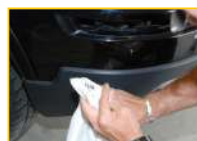
La couleur des chiffons Ultra Clean est idéale pour vérifier si vous avez bien nettoyé et dégraissé. Ces chiffons blancs vous permettront de voir rapidement s'il reste de la saleté dans ces coins difficiles d'accès avant de commencer l'application.
