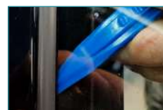
L'extrémité incurvée se rétrécit et est idéale pour pousser le film dans les coins et exercer une pression supplémentaire sur la face arrière des bords, panneaux, portes, etc.
