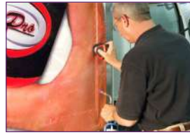
Réchauffez le film et roulez RollePro simplement sur les canaux, rainures ou joints de rivets.
