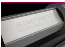
Les guides des rouleaux sont fabriqués en aluminium anodisé avec un profil métallique sur toute la longueur pour éviter tout affaissement
