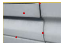
Une bonne application dépend d'une bonne adhérence. Cela va sans dire. Malheureusement, le nettoyage et le dégraissage des zones les plus critiques sont négligés. Il s'agit notamment des joints, des rebords et des interstices de la carrosserie. C'est exactement là que le film a tendance à se détacher et à gondoler.
