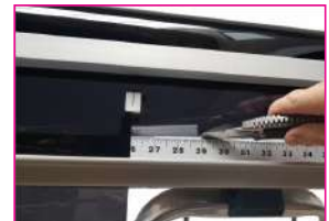
Le long du guide horizontal, coupez le film à la taille voulue.
