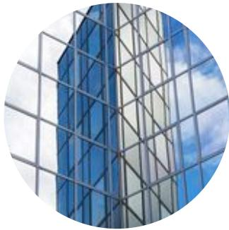
Пленки Silver 385 XC очень эффективны для уменьшения прироста солнечного тепла, в то же время сохраняя некоторую естественную передачу света. Эта пленка обеспечивает эффективную защиту от солнечных бликов, в то время как ее очень не интенсивное одностороннее зеркальное отражение дополнительно гарантирует конфиденциальность от посторонних глаз. Его современный дизайн сразу придает современный вид любому экsterьеру здания.
